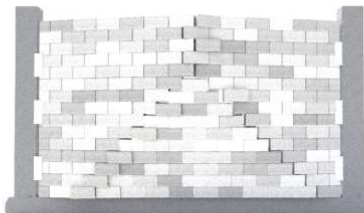
مسلح به میلگردبستر یک رج در میان با قطر مفتول ۳/۵ میلیمتر
