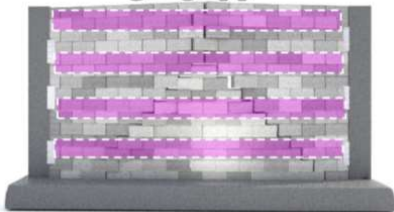
کامپوزیت شبکه الیاف به صورت نوارهای افقی
