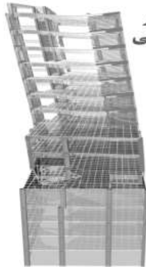
سیستم باربر جانبی در امتداد شرقی - غربی دیوار برشی بتنی
