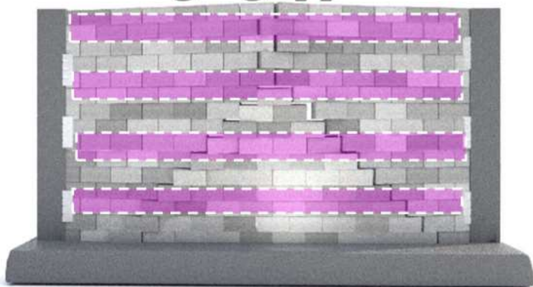
کامپوزیت شبکه الیاف به صورت نوارهای افقی
