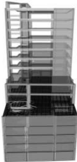
سیستم باربر جانبی در امتداد شرقی - غربی دیوار برشی بتنی
