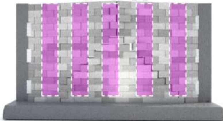
کامپوزیت شبکه الیاف به صورت نوارهای قائم
